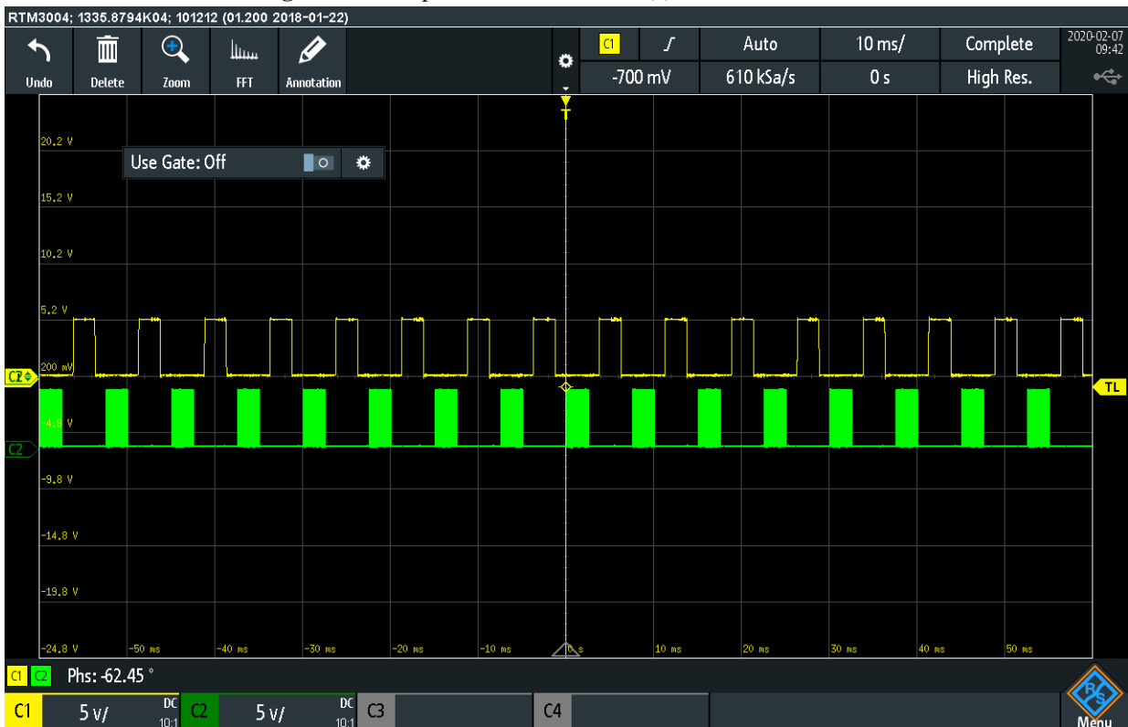
Fig 5. BLDC Experimental Parameters (d) PWM Pulses.
