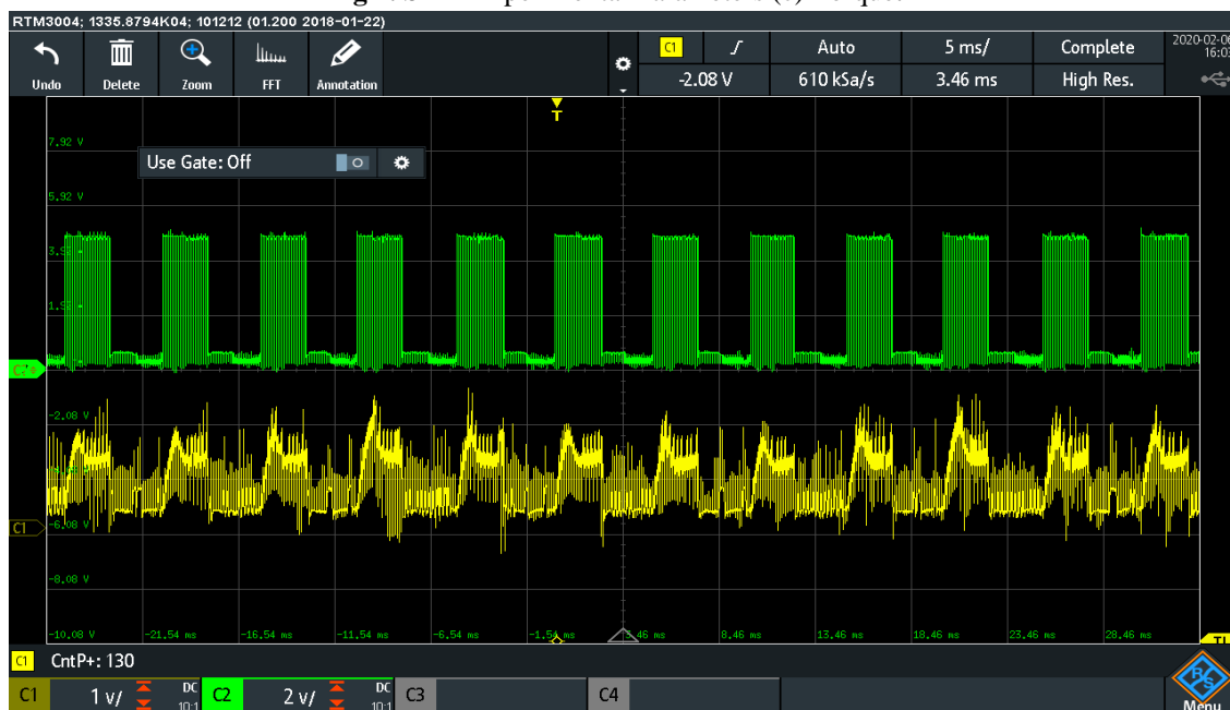
Fig 7. SRM Experimental Parameters (d) PWM & I_d .
