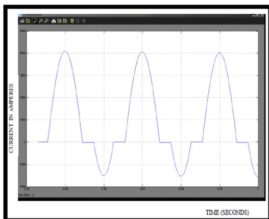
Fig 1.6 (d) Operating under CT-Saturation
