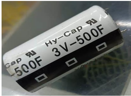
Fig. 5. Super capacitor module
