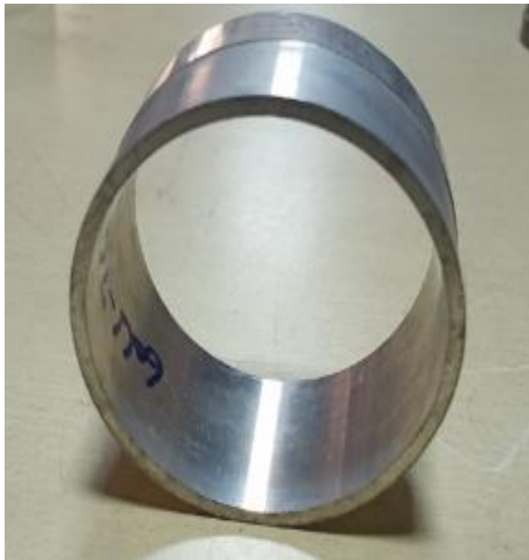
Fig. 9. Al6061 T6-Flyer (Before weld)
