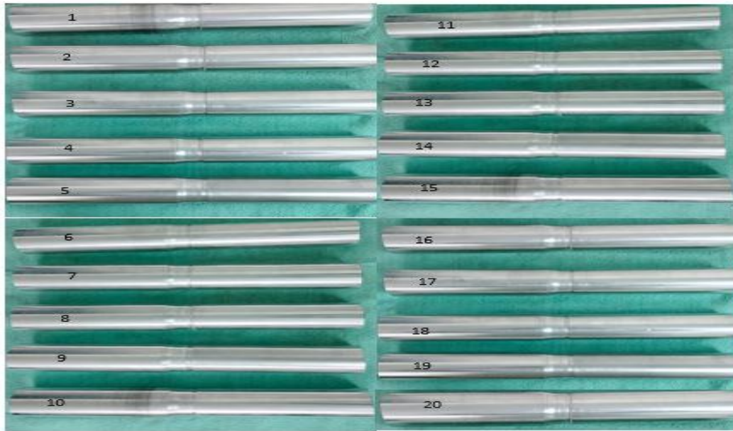
Fig. 16. Weld Specimen (20 nos.)
